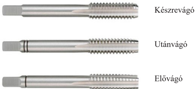
13. ábra. Menetfúrók geometriai kialakítása egy konkrét menetgeometria esetére [16]
