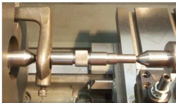
6. ábra. Munkadarab központosítás kúpokkal, meghajtás esztergaszívvel [18]
